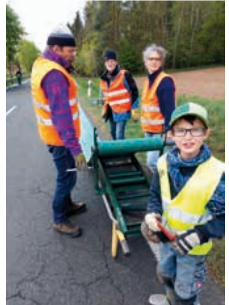
Roßtal: Beim Zaunabbau sorgte die Aufwickelvorrichtung, die der Landkreis-Bauhof konstruiert hatte, für Erleichterung.
